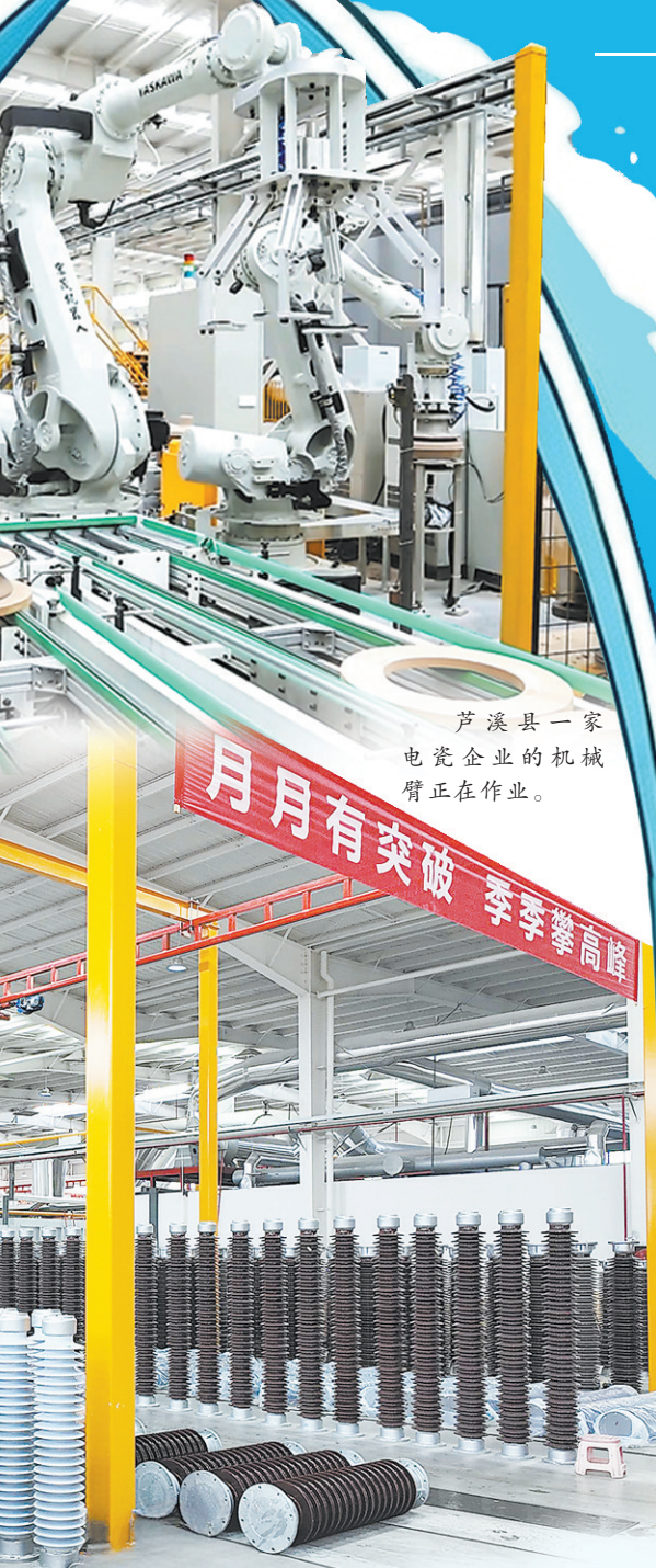
中材江西电瓷电气有限公司生产的棒型支柱瓷绝缘子。 (芦溪县融媒体中心供图)
