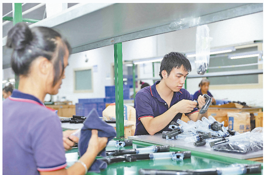
工人正在装配呼吸管。
