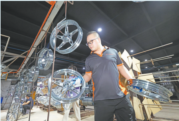
工人将轮毂投入喷漆加工线上。
