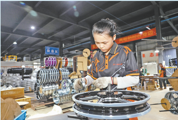
工人在进行轮毂中心重力平衡测试。
