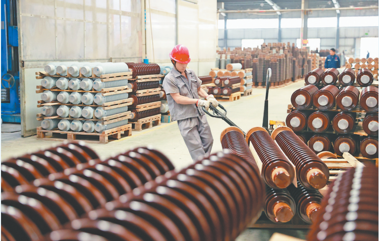
在中材江西电瓷电气有限公司,工人转运烧制好的棒形支柱瓷绝缘子。
