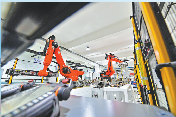
工业机器人正在装配变压器。
