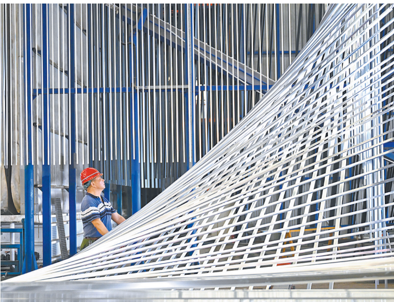
近日，在位于奉新县宋埠镇的江西纳奇铝业有限公司生产车间内，工作人员有序把铝型材挂上立式喷涂生产线，加紧完成各类订单生产。
